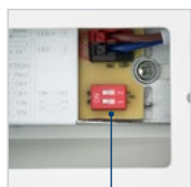
Integrovaný přepínač světelného toku
